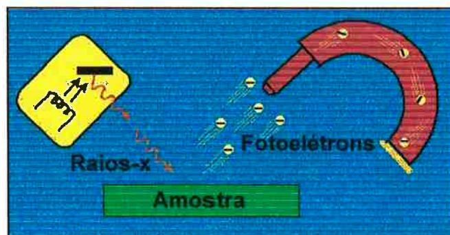
Figura 22. Esquema de funcionamento de um espectrômetro de fotoemissão
